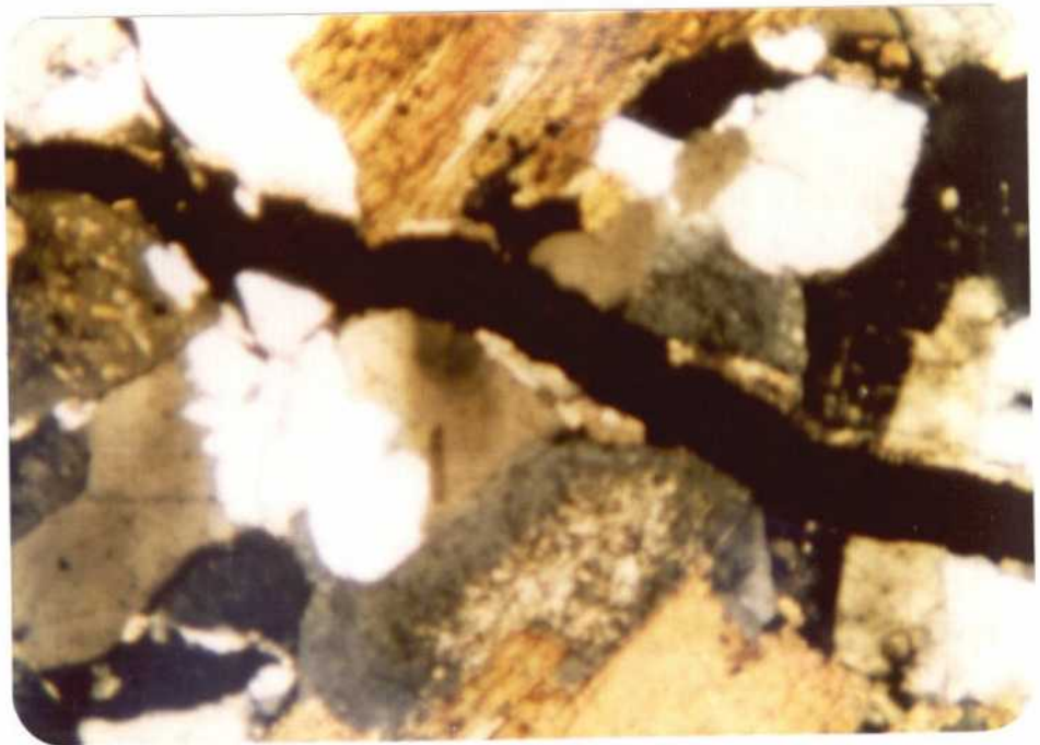
Fotografía nº 43 Lámina delgada de la muestra S3-1 = 160 MPa.
