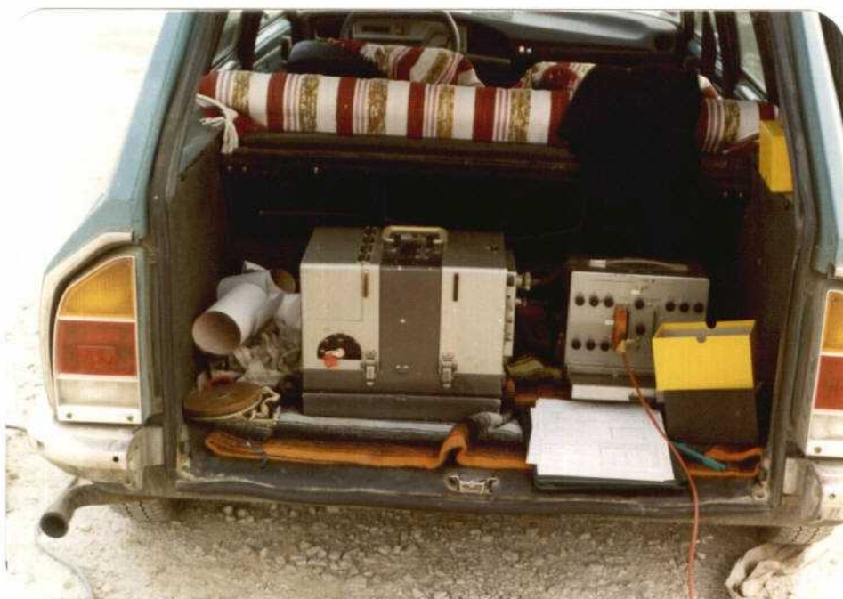
Fotografía n o 51 Equipo de registro para CROSS y DOWN-HOLE.
