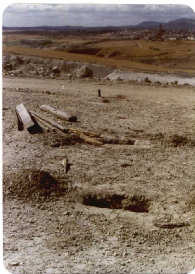
Fotografía n o 48 Entubado del sondeo y calicata para generar impulsos.-
