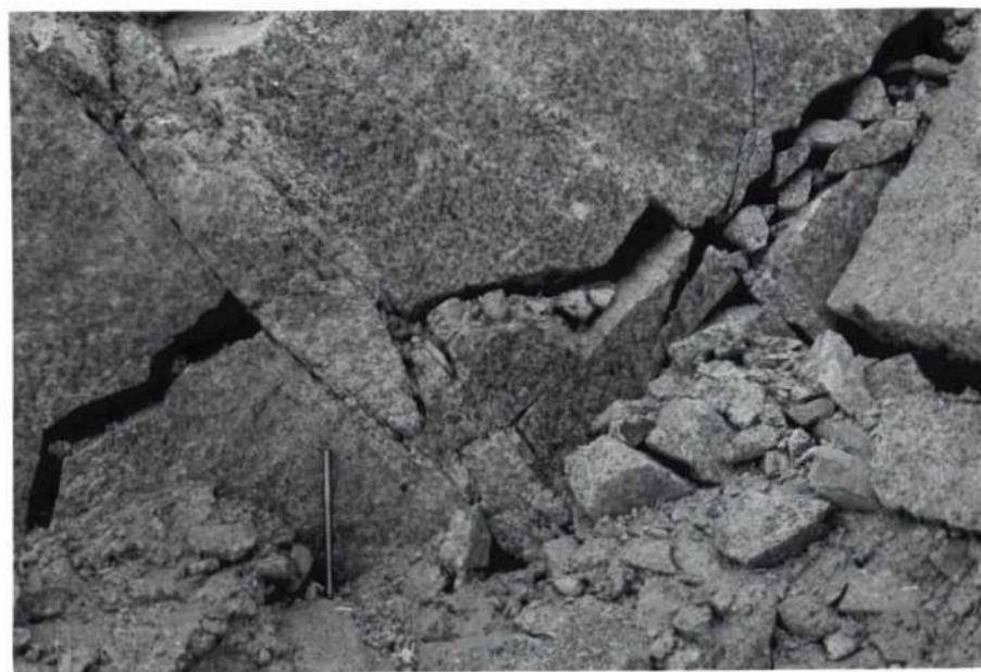
FOTOGRAFIA Nº 23 DETALLE DE CRUCE DE DISCONTINUIDADES
