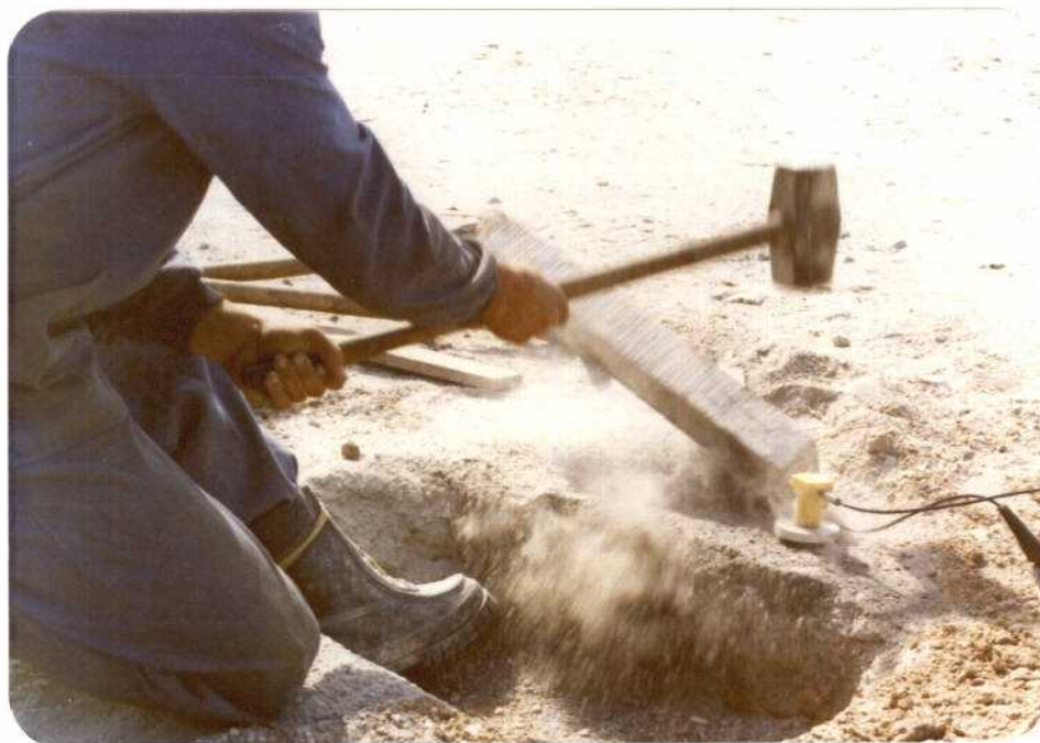
Fotografía nº 46 Impulso para generar onda "P"
