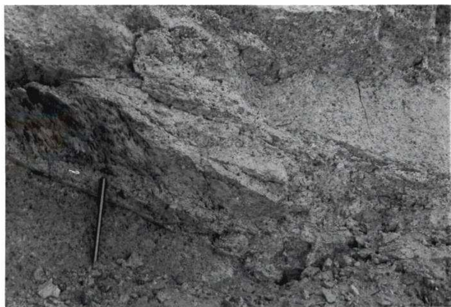
FOTOGRAFIA Nº 21 DETALLE DE RELLENO LAJOSO SIN DESPLAZAMIENTO LATERAL
