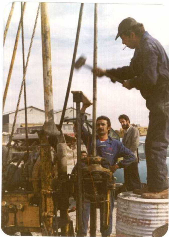
Fotografía n o 50 Generación de impulsos para CROSS-HOLE.
